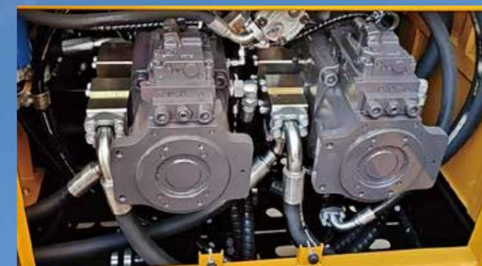
采用知名品牌双联柱塞泵组, 泵流量达  $4 \times 500$  L/min, 带压力切断功能, 降低溢流损失。
